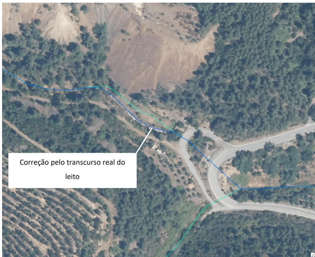
Figura 6. Exemplo de correção do traçado (leito) da ribeira das Casinhas, segundo o seu transcurso real observado nos ortofotomapas do ano 2018 e 2021 da DGT (linha azul-escuro: linha de leito a incluir na tipologia CALM | linha azul-claro: leito identificado na cartografia de base)
