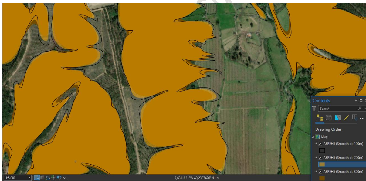
Figura 41. Comparação dos resultados da suavização, através do algoritmo “PAEK da ferramenta “Smooth Polygon”, para os valores de tolerância de 100m (limite preto), 200m (laranja) e 300m (castanho)
